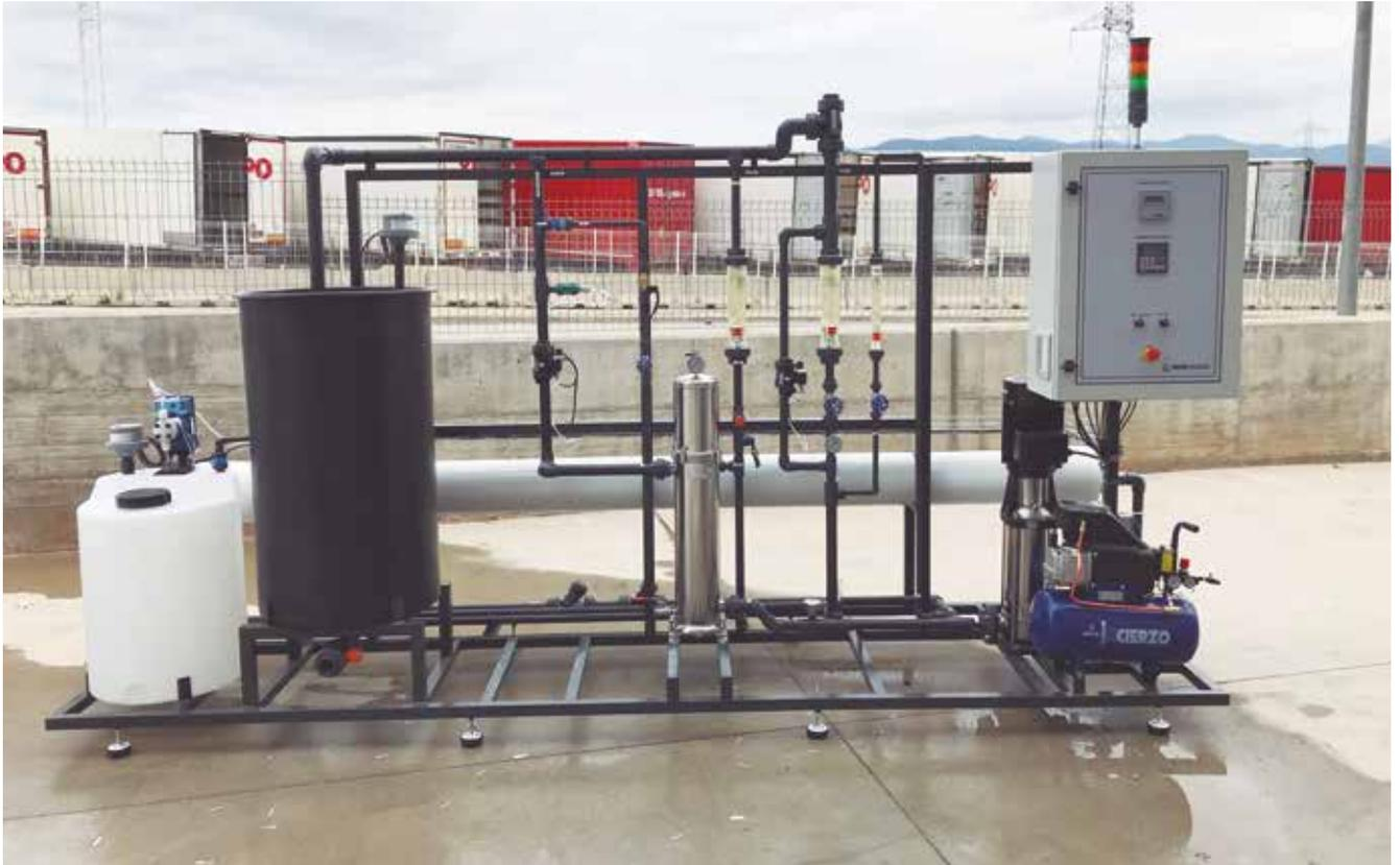
Planta de ósmosis inversa de 60 m<sup>3</sup>/d instalada en Argelia.
